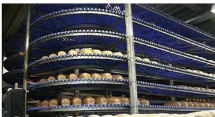
Durch den kleinen Innenradius von nur 1,3 x Bandbreite ist JP Link platzsparend und kann in fast allen Produktionsumgebungen eingesetzt werden. Das JP Link System sorgt dafür, daß die Produkte auch nach dem Durchlauf mehrerer Kurven für den nächsten Arbeitsprozess gut positioniert liegenbleiben.
