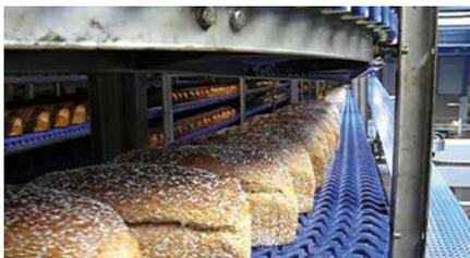
Da das Band aus verschiedenen Panelen (Modulen) zusammengesetzt wird, ist die Bandoberfläche offen und nicht komplett geschlossen. Durch die offene Banddecke können Flüssigkeiten tropfen, so dass das JP Link System in Nassumgebungen eingesetzt werden kann. Im geraden, gestreckten Zustand ist der Durchlass 36 % der Gesamtoberfläche. Das Material ist FDA lebensmittelzugelassen und das Banddesign sehr leicht zu reinigen.
