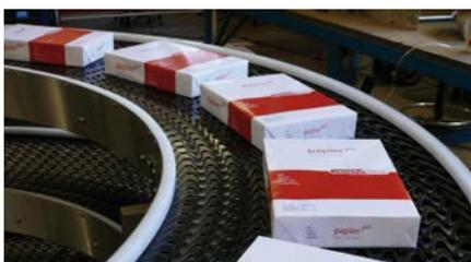
Beschädigte Produkte, verpackt oder unverpackt, gehören hierdurch der Vergangenheit an. Außerdem ersetzt ein JP Link System mehrere angetriebene Transportanlagen und Kurvenbandanlagen durch sein Endlossystem. In manchen Fällen genügt nur das Band im Obertrum, wodurch ein Untertrum entfällt.
